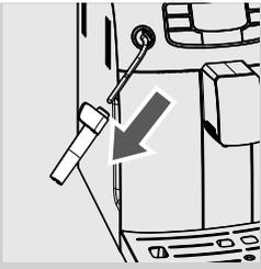
**2** Retire o Batedor de leite clássico do tubo de vapor/água quente.
