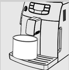
**8** Posicione um recipiente com capacidade suficiente (1,5 l) sob o tubo de vapor/água quente e sob o distribuidor.
