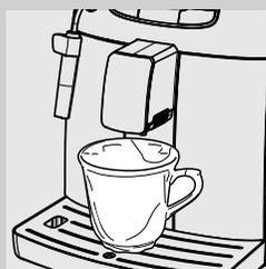
Sob o distribuidor podem ser colocadas duas chávenas, grandes/pequenas, para distribuir simultaneamente dois cafés.
